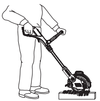
Arbeidsposisjon 3: Loddrett trimming av overhengende kanter til plenen
