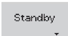
13. Примерно через 10 секунд после закрытия запорных устройств насос автоматически выключается. Нормальный режим (ожидание) достигнут.
