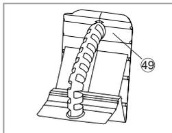
Ваша газонокосилка снабжена вставкой для мульчирования <sup>49</sup>. Вставка для мульчирования препятствует сбору травы, блокируя собирающий желоб на дне платформы.
