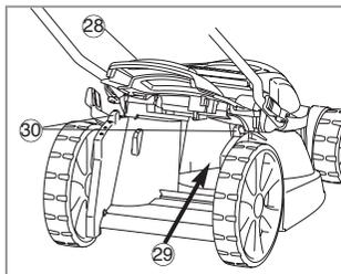
1. Поднимите предохранительный щиток 28.
