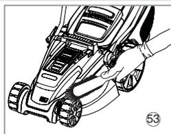
2. С помощью мягкой щетки удалите обрезки травы из всех воздухозаборников <sup>53</sup>, разгрузочного желоба <sup>54</sup> и контейнера для <sup>55</sup>.
