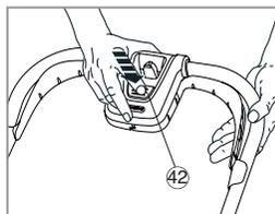
Пожалуйста, обратите внимание: - При запуске Вашей газонокосилки будет небольшая задержка после нажатия рычага, а затем газонокосилка нарастит скорость до полной.
