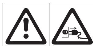
Desligue imediatamente a ficha da tomada de corrente principal se o cabo de ligação se encontrar danificado ou cortado.
